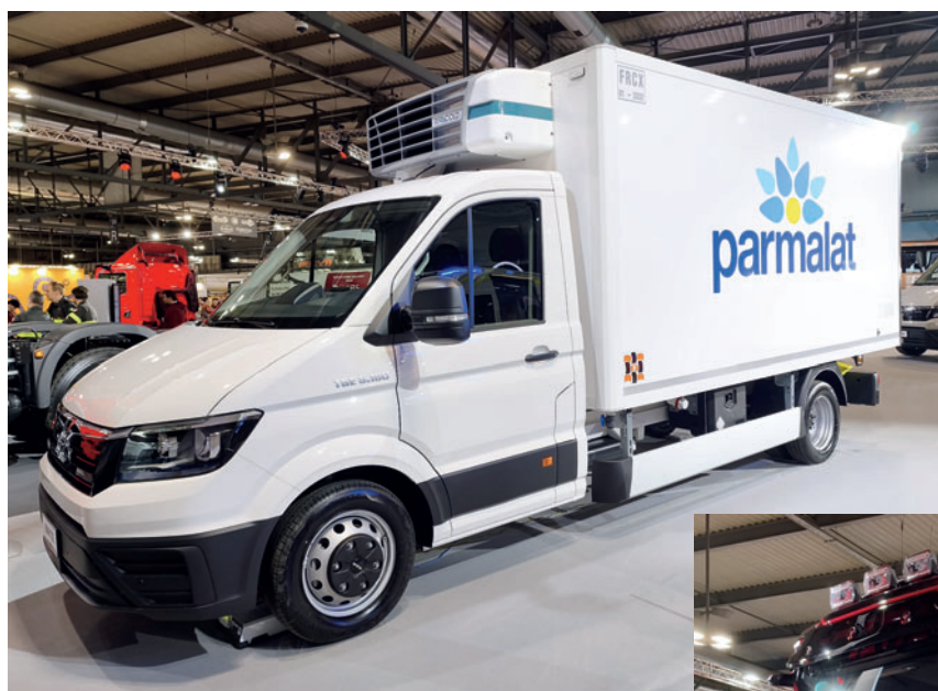
TGE 6.160 z zabudową chłodniczą i agregatem RivaCold
