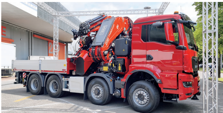
Nie brakowało pojazdów o ciekawych konfiguracjach specjalistycznych – na zdjęciu MAN TGS 35.520 8x4 z żurawiem Fassi F1450HXP i zabudową skrzyniową, całość przygotowała firma Officine BPM
