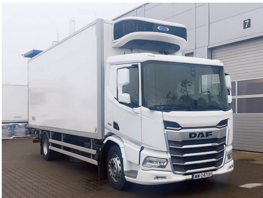
Bohater testu: DAF XD 310 FA z zabudową chłodniczą Igloocar, agregatem chłodniczym Carrier Supra HE9 i tylnym podestem ładowniczym Bär Cargolift BC 1500S4L
