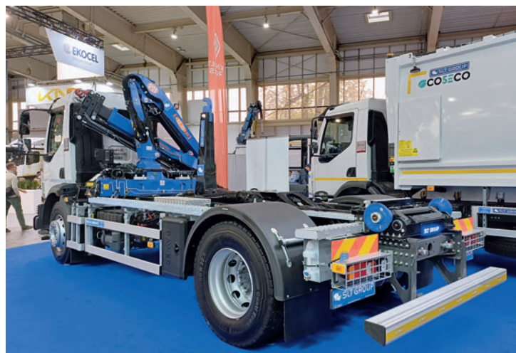
Hakowiec HSL 8 oraz żuraw PM 8.5P na 18-tonowym podwoziu Renault Trucks D to propozycja skierowana do branży komunalnej, budownictwa, transportu surowców oraz recyklingu
