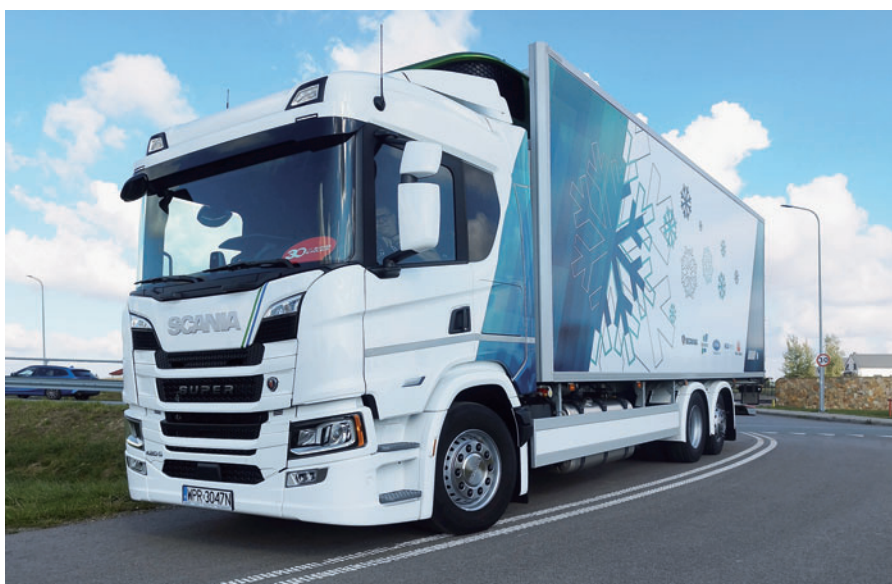
Bohaterka testu: Scania G420 B 6×2*4 z zabudową chłodniczą Igloocar, agregatem chłodniczym Carrier Supra HE9 i tylnym podestem załadowniczym Dhollandia DH-SM.20
