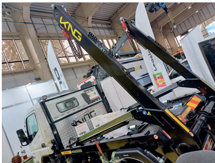
Mercedes-Benz Atego 1624 z urządzeniem hakowym KING HZ-6R i maszyną do zagęszczania odpadów Dreiger
