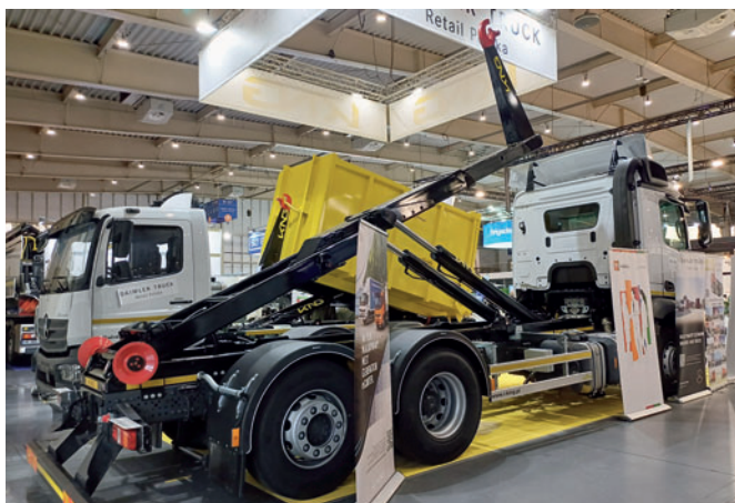
Na wspólnym stoisku Daimler Truck Retail i KING Zabudowy Pojazdów zaprezentowano 3-osiowe podwozie Mercedes-Benz Actros 2542 z zabudową hakową KING HZ-20R
