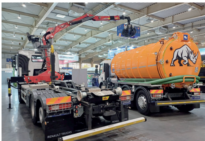
Na wspólnym stoisku SLT Group i Renault Trucks Polska wśród 7 pokazanych pojazdów można było obejrzeć m.in. samochód przeznaczony dla branży złomowej – podwozie Renault Trucks C480 z zabudową hakową Hyva 20 i żurawiem PENZ za kabiną oraz beczkę asenizacyjną o pojemności 15 tys. l zamontowaną na podwoziu Renault Trucks D Wide 320 6x2
