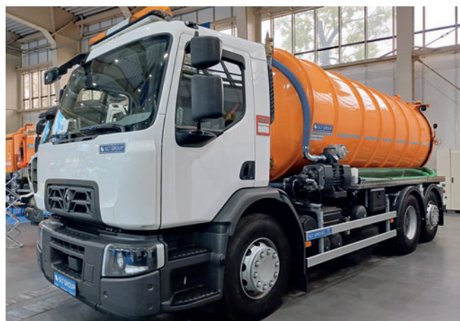
Przygotowana przez SLT Group beczka asenizacyjna o pojemności 15 tys. l na podwoziu Renault Trucks D Wide 320 6x2 wyróżnia się nie tylko jakością i funkcjonalnością, ale także estetyką wykonania
