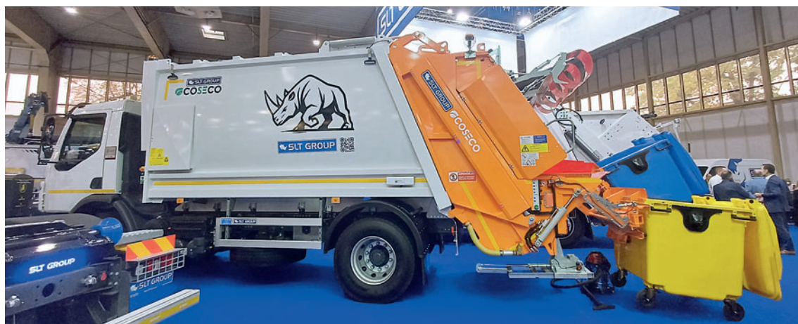
Wspólne dzieło firm Renault Trucks Polska oraz SLT Group to dwukomorowa śmieciarka Cosesco typu 50/50 zamontowana na wytrzymałym 2-osiowym podwoziu Renault Trucks D
