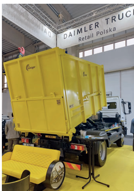
Mercedes-Benz Atego 1624 z urządzeniem hakowym KING HZ-6R i maszyną do zagęszczania odpadów Dreiger
