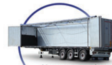
Naczepa z ruchomą podłogą z otwieranym bokiem i przesuwającym słupkiem
