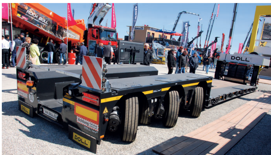
Trzyosiowa naczepa niskopodwoziowa z osiami wahlivymi Doll tera wyposażona była we wnękę na ramię koparki o szerokości 900 mm i głębokości 550 mm
