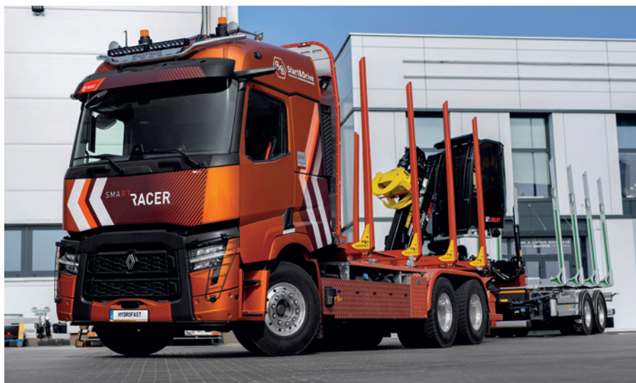
Zmodernizowany model C520 6×4 Smart Racer z zabudową aluminiową Hydrofast na ławach HF5 do drewna stosowego i żurawiem Hiab Loglift 125Z z kabiną
