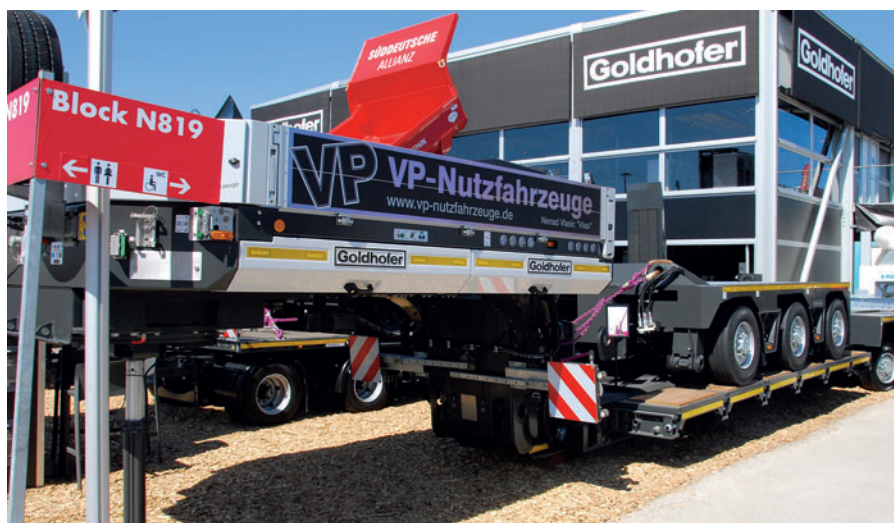
Goldhofer STEPSTAR z rodziny STARLINE ma niską wysokość jazdy wynoszącą 790 mm, jest wyposażona w różne opcje zabezpieczania ładunku oraz innowacyjną podłogę TRAFFIDECK GO
