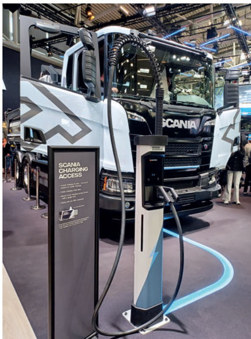
Elektryczna Scania R40 6×4 XT z trójstronną wywrotką Meiller TRIGENIUS; do tego pojazdu producent oferuje usługę Scania Charging Acces ułatwiającą korzystanie z publicznych punktów ładowania
