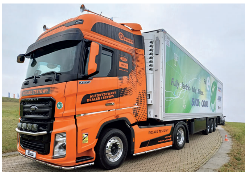
Jeden z pojazdów na torze – model F-MAX 500 wyposażony w 16-biegową skrzynię ecorq, spięty z elektryczną naczepą Schmitz Cargobull S.K0e Cool
