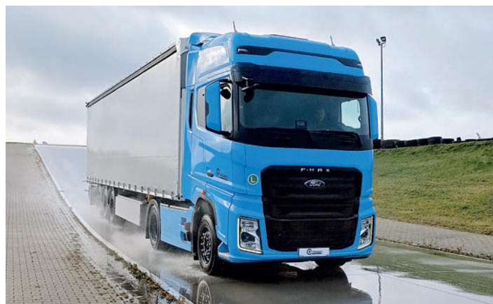
Pojazdy Ford Trucks podczas jazdy na mokrej nawierzchni i w kontrolowanym poślizgu na płycie poślizgowej
