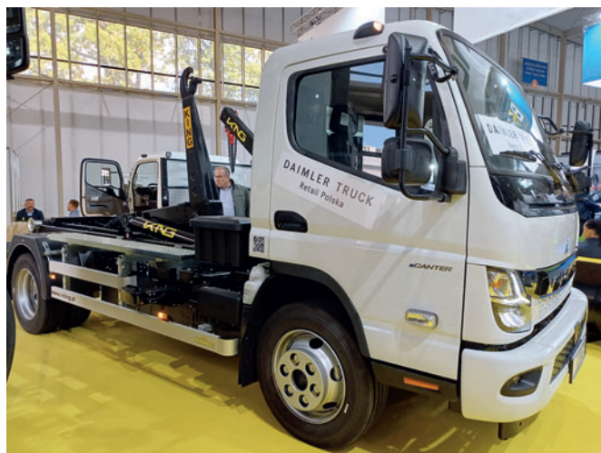
Fuso eCanter 9C18e nowej generacji z zabudową hakową KING HZ-6R
