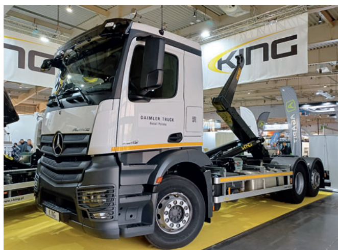
Hakowiec KING HZ-20R na 3-osiowym podwoziu Mercedes-Benz Actros 2542
