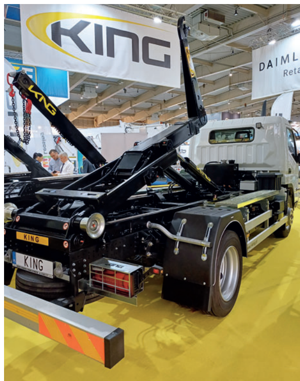
Fuso eCanter 9C18e nowej generacji z zabudową hakową KING HZ-6R
