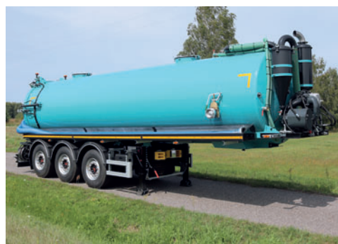
Naczepy specjalistyczne asenizacyjne o pojemności 26 000 – 28 000 l do przewozu nieczystości płynnych to seria z 3 osiami stalymi – pierwszą podnoszoną
