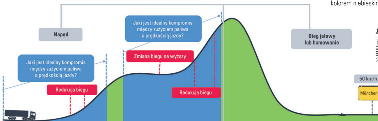
Rysunek 2. Potencjał rozszerzenia możliwości działania funkcji MAN EfficientCruise – dotychczas nie wykorzystywane obszary działania zaznaczono kolorem niebieskim
