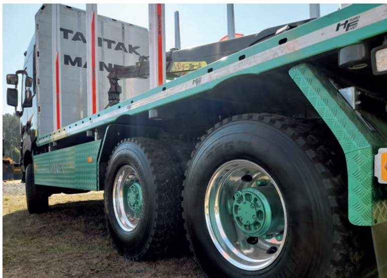
Felgi aluminiowe Alcoa Wheels Dura-Bright – ich użytkowanie nie tylko obniża masę pojazdu, ale i koszty eksploatacji floty
