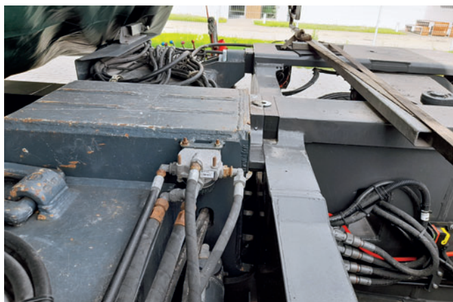
Połączone moduły serii UT (z lewej) i nowe FT (z prawej): taka sama wysokość ramy i pokładu, nie widać żadnej różnicy podczas łączenia
