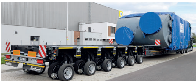
Połączone moduły serii UT (z lewej) i nowe FT (z prawej): taka sama wysokość ramy i pokładu, nie widać żadnej różnicy podczas łączenia
