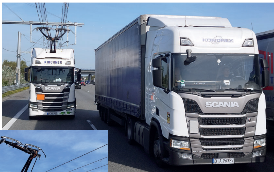
Schematyczne przedstawienie testowych odcinków z siecią napowietrzną, zbudowanych w ramach projektu ELISA
