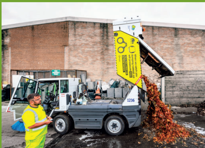
W zmiatarce Schmidt eSwingo 200+ zbiornik na odpady ma pojemność 2 m 3 , jego wysokość opróżniania wynosi 1400 mm
