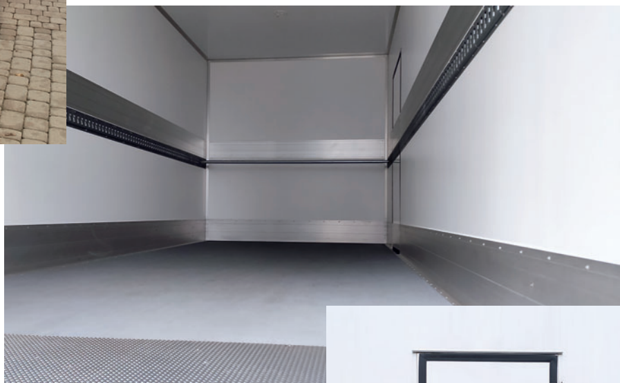
Zabudowa izotermiczna Igloocar – bardzo staranne wykończenie, estetyczne wykonanie, choć zabrakło chyba bocznej drabinki wejściowej
