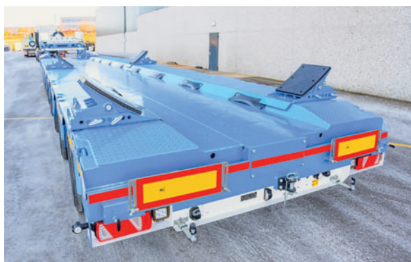
Naczepy MultiMAX przeznaczone do transportu segmentów wież elektrowni wiatrowych mają od 6 do 8 osi, a wysokość pokładu ładunkowego w położeniu do jazdy to 730 mm
